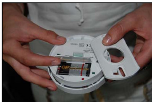
Obr. 4: Autonomní hlásič kouře (detail) – napájení baterií.
